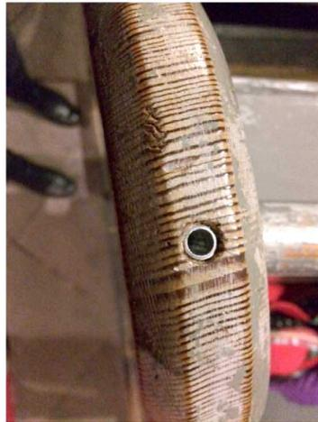
Bohrung als Halterbefestigung
